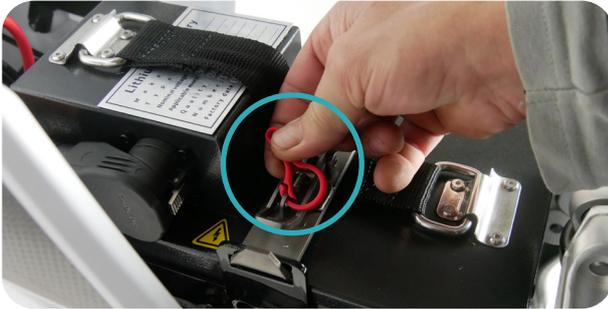
Pour retirer la batterie, vous devez dans un premier temps retirer le clip rouge. Possibilité de mettre un cadenas pour verrouiller la batterie.
